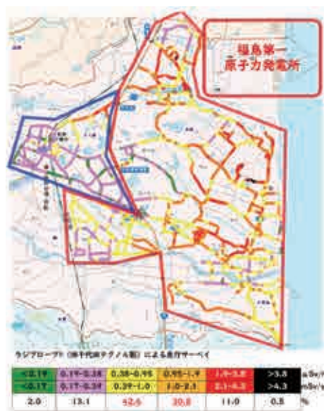
図 走行サーベイによる線量マッピング
