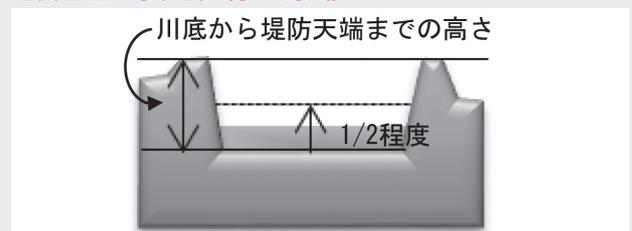
※危機管理型水位計は、河川水位が川底から堤防天端までの高さの 1/2 程度を超えた際に観測を開始する水位計です。
