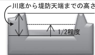
※危機管理型水位計は、河川水位が川底から堤防天端までの高さの 1/2 程度を超えた際に観測を開始する水位計です。
