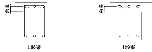
図2-3-5 スラブ付梁のあばら筋(末端部がフックの場合)
