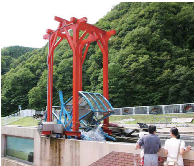
鮭を捕獲するインディアン水車（北海道豊浦町ホームページより引用）
