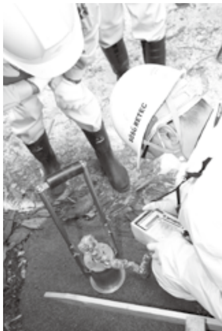
▲放射線量を測り除染効果を確認する
